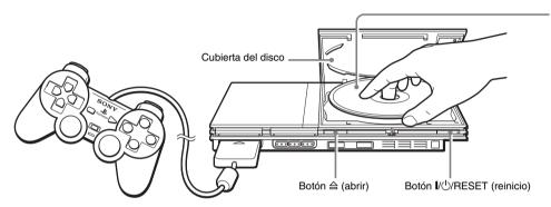
Inserte el disco en la consola con la cara de la etiqueta hacia arriba.
