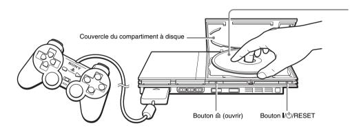
Insérez le disque dans la console, l'étiquette orientée vers le haut
